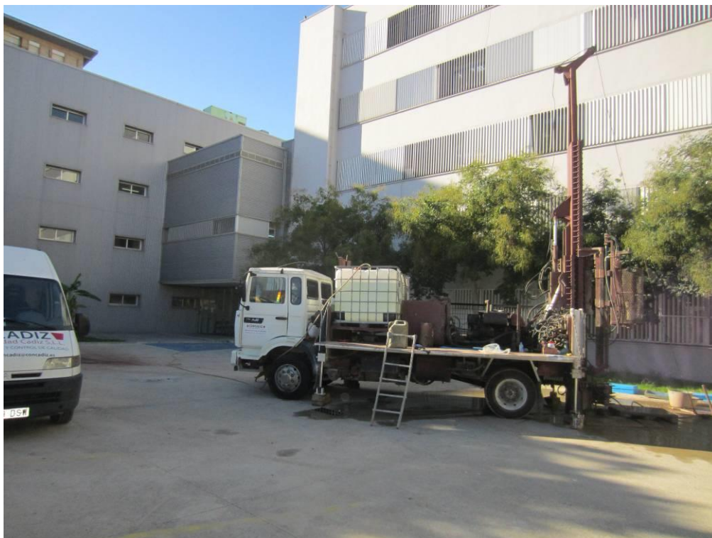
Emplazamiento de la sonda testiguera a rotación en el punto reseñado como SR-2. Al fondo los edificios medianeros.
